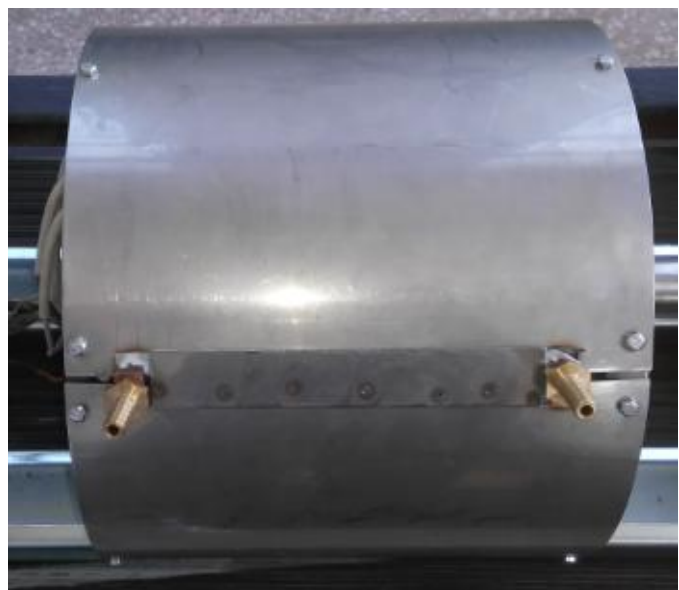
a) Vedere exterioră a GEH cu evidențierea carcasei și a ștuțurilor de intrare/ieșire ale circuitului termic.
