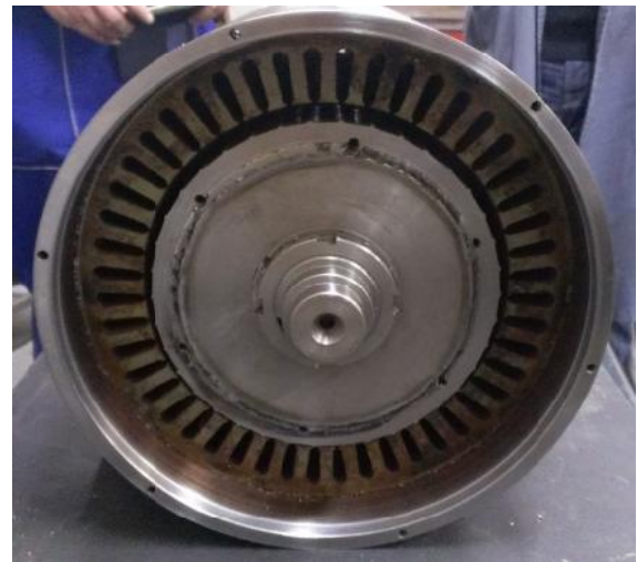
b) Subansambluri arbore, miez rotor, miez stator suport circuit termic, fără magneți.
